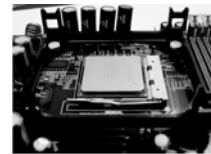
SCHRITT 4: Den Hebel des Sockels runterdrücken und verriegeln.
